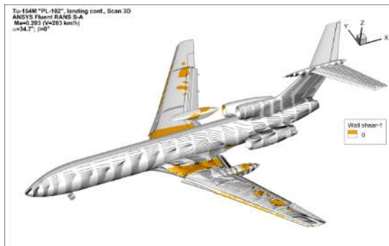
Rys. 46. Zobrazowanie obszarów oderwań oraz przebiegu linii prądu na górnej powierzchni płatowca samolotu Tu-154M w konfiguracji do lądowania dla \alpha = 4.7^\circ \div 40.7^\circ .
