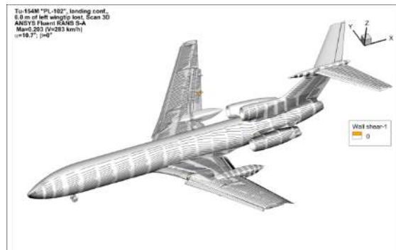
Rys. 49. Zobrazowanie obszarów oderwań oraz przebiegu linii prądu na górnej powierzchni płatu samolotu Tu-154M w konfiguracji do lądowania z urwaną końcówką lewego skrzydła o rozpiętości 6 m dla \alpha = -35.3^\circ \div 0.7^\circ .
