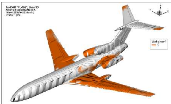
Rys. 44. Zobrazowanie obszarów oderwań oraz przebiegu linii prądu na powierzchni płatowca samolotu Tu-154M w konfiguracji przelotowej dla \alpha = 4.7^\circ \div 40.7^\circ .
