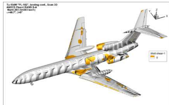
Rys. 46. Zobrazowanie obszarów oderwań oraz przebiegu linii prądu na górnej powierzchni płatowca samolotu Tu-154M w konfiguracji do lądowania dla \alpha = 4.7^\circ \div 40.7^\circ .
