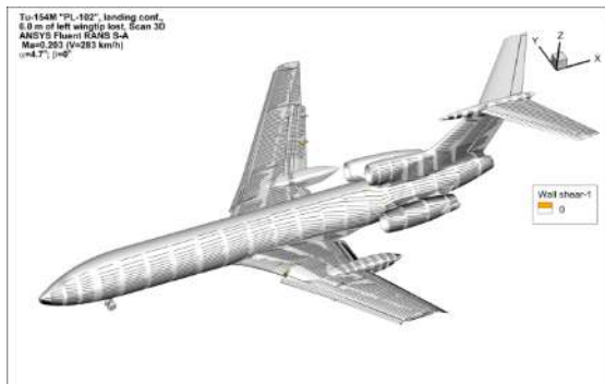
Rys. 49. Zobrazowanie obszarów oderwań oraz przebiegu linii prądu na górnej powierzchni płatu samolotu Tu-154M w konfiguracji do lądowania z urwaną końcówką lewego skrzydła o rozpiętości 6 m dla \alpha = -35.3^\circ \div 0.7^\circ .
